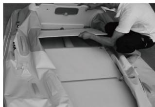
c. 中央のセクションを少し付け足し、屋根のような構造を作成して下さい。(Fig.3)
